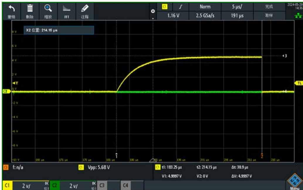
图 3.3 外挂 39KΩ 电平抬升至 5V 波形图
