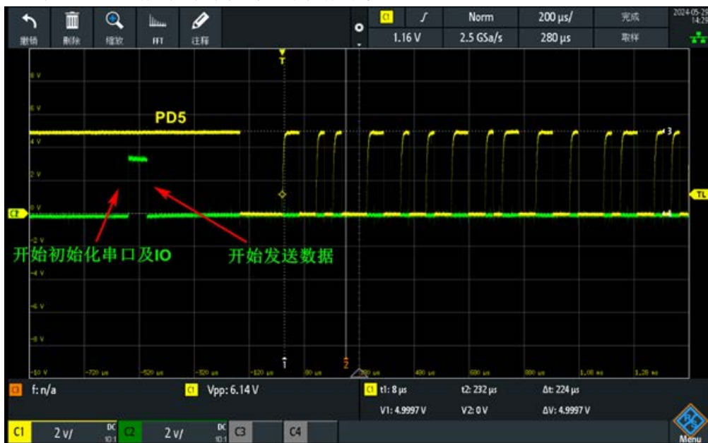
图 3.1 UART2_TX 外挂 39KΩ 通信波形图
