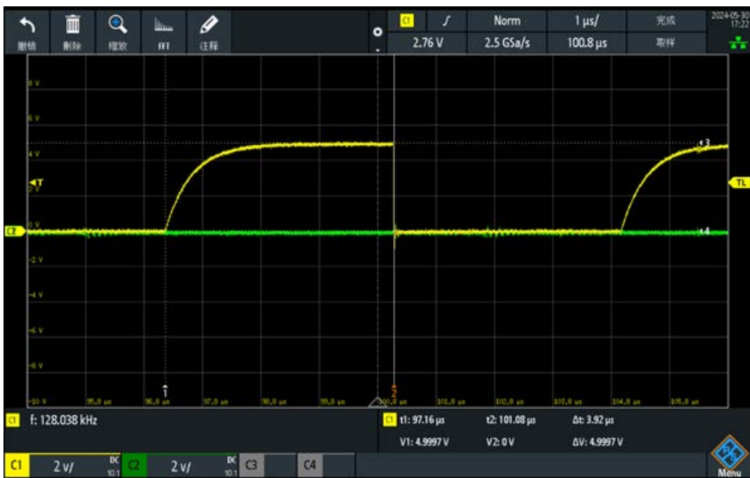
图 3.6 外挂 39KΩ 电平抬升至 5V 波形图
