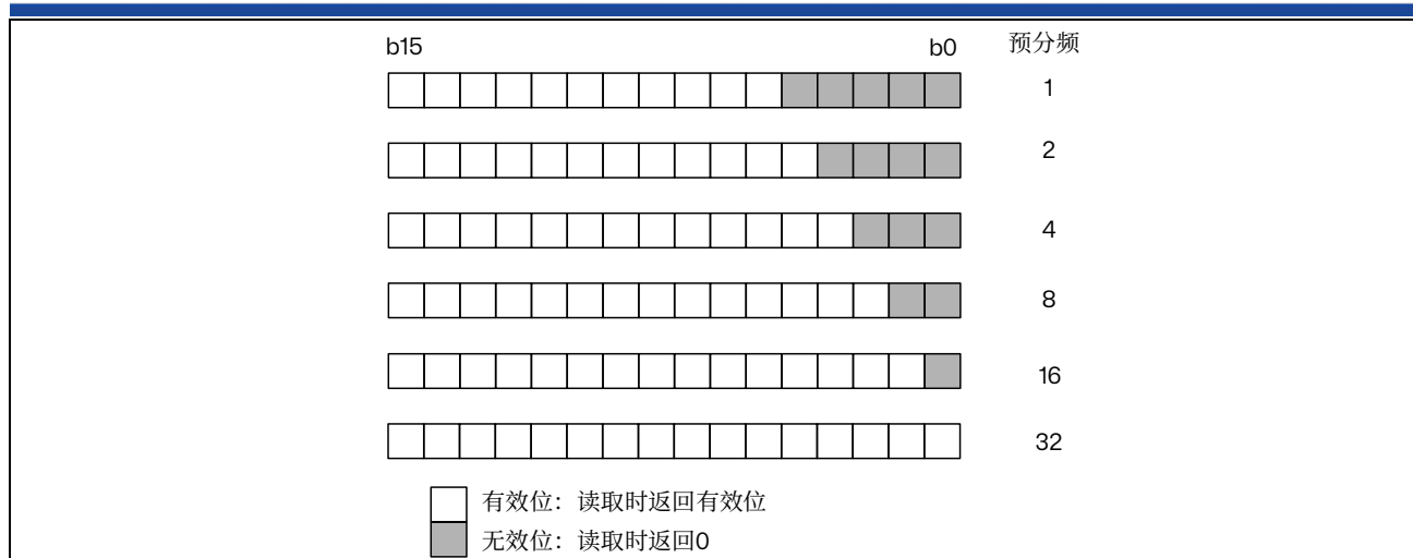
图 22.2 计数器和捕获寄存器格式与时钟预分频系数
